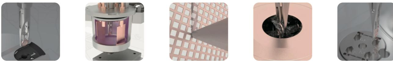
夹取载网 > 亲水化处理 > 可视化针式书写 > 喷射式冷冻玻璃化 > 转移至载网盒
